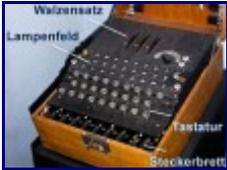
Neben den Walzen (austauschbar, bis zu 8 verschiedene normale plus Beta und Gamma als vierte Walze bei der M4) hatten die hier relevanten Enigmas noch eine Umkehrwalze (UKW-B oder C), außerdem eine Tastatur, ein Lampenfeld, was den ver-/bzw. entschlüsselten Buchstaben darstellte und ein Steckbrett, mit dem die Buchstaben noch einmal paarweise verwürfelt worden sind; wodurch die Sicherheit der Verschlüsselung noch einmal enorm verstärkt worden ist.
