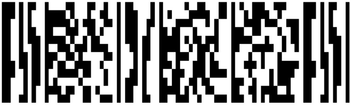
Code PDF417: Stapelcode mit starker Fehlerkorrektur. Besteht aus einzelnen Elementen, den "Codewörtern", welche aus je 17 Modulen aufgeteilt in 4 Striche und 4 Lücken bestehen.
